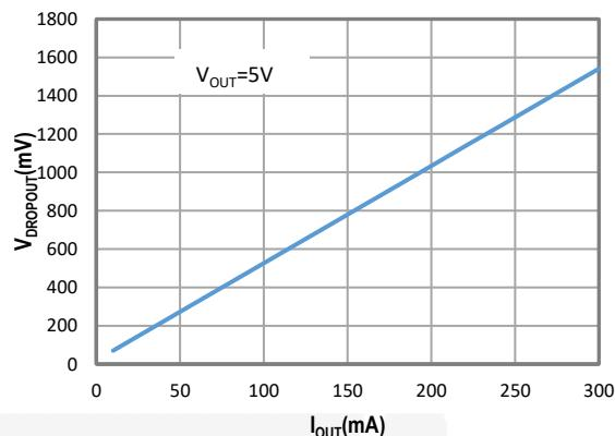
$V_{DROPOUT}$  Vs.  $I_{OUT}$
