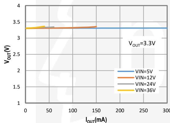
$V_{\text{OUT}}$  Vs.  $V_{\text{IN}}$
